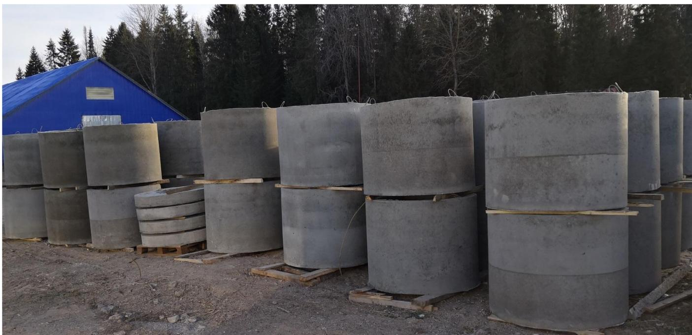
Основное назначение железобетонных колодцев – это элементы заглубленных сооружений, которые эксплуатируются выше или ниже уровня грунтовых вод в условиях неагрессивных или же слабоагрессивных сред. Колодцы бетонные применяются в промышленном, жилом и дорожном строительстве, для организации инженерных и тепловых сетей, канализационных трубопроводов.
